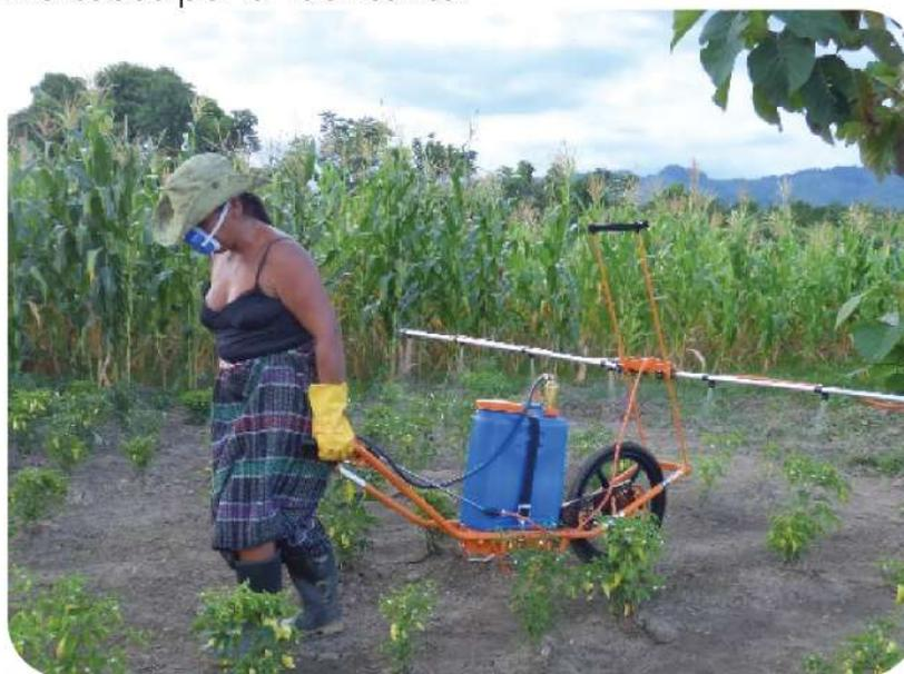
La bomba es accionada por una palanca conectada a la rueda. Se puede cambiar la posición de la barra en relación con la superficie del suelo, lo cual es útil en laderas. La altura de la barra también es ajustable de acuerdo con el porte de las plantas, hasta una altura de 1 metro 20 centímetros de alto y una altura mínima para la pulverización de 70 centímetros desde el suelo.
